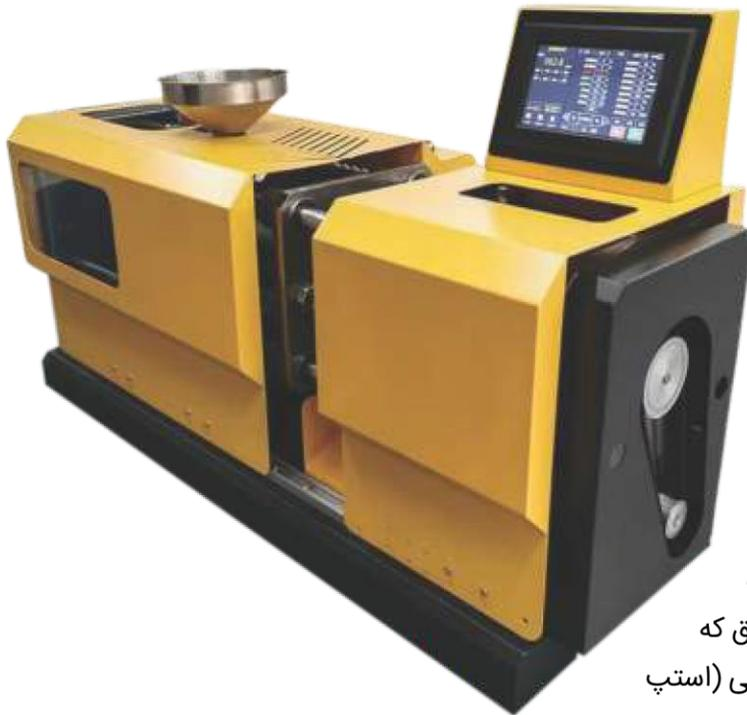
نوعی دستگاه تزریق پلاستیک که برای ساخت قطعات کوچک پلاستیکی از آن استفاده می شود. در این دستگاه، حداکثر دما تزریقی در حد ۱۵ تا ۲۰ گرم است. ویژگی های اصلی این دستگاه که آن را از دستگاه های مرسوم تزریق متمایز می کند، این موارد هستند:
